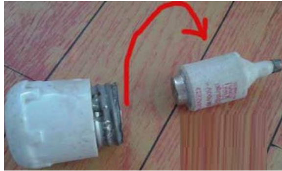
Gambar contoh mengganti sekering yang bermasalah
